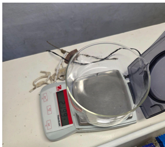
Figura 1: Instrumental de pesaje utilizado en el laboratorio. (a) Balanza digital de plataforma empleada para la masa bruta por diferencia de tara. (b) Balanza analítica/precisión empleada para los ensayos gravimétricos de humedad y densidad.
