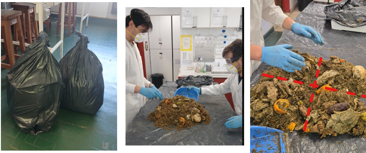
Figura 2: Secuencia fotográfica del procedimiento de homogeneización y cuarteo (Norma IRAM 29523). De izquierda a derecha: acopio e inspección de las bolsas recolectadas; mezclado y conformado del cono sobre la lona impermeable; y división transversal en cuadrantes para la obtención de la muestra representativa.
