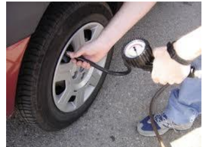
Fig. 7.8. La presión manométrica de las cubiertas se mide aún hoy en psi.
