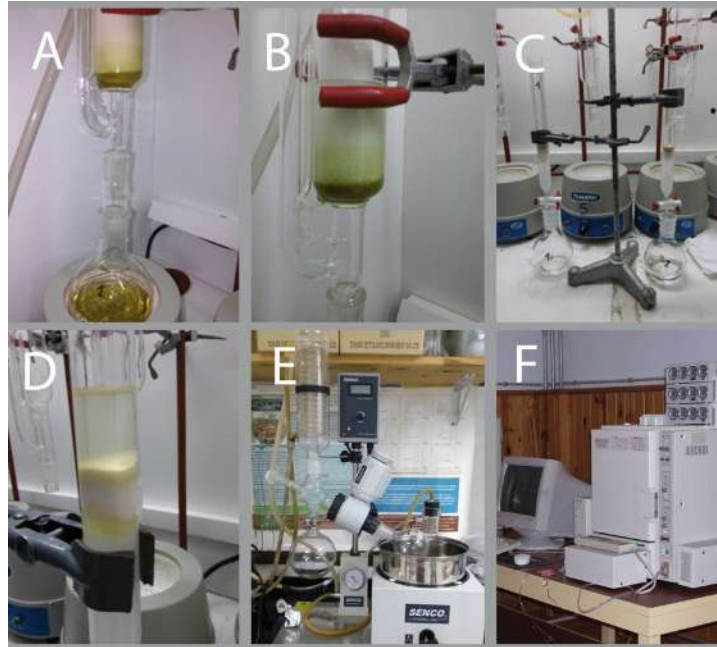
Figura 9. Distintas fases metodológicas: A: Inicio del proceso de extracción en el soxhlet con solventes; B, C, D: Columnas de clean-up listas para sembrar la muestra; Sembrado y Elución de la muestra en la columna; E: Rotoevaporación; F: Cromatografía Capilar Gaseosa-Espectrometría de Masas
